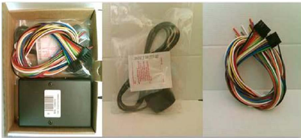
Рис.2. Устройство FM Tco3, кабели питания и ввода/вывода, а также антенна GPS/GLONASS.
